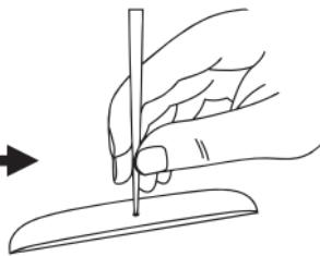
Натисніть та утримуйте кнопку налаштування для вибору потрібної функції: гучності звуку, одиниці вимірю, дзеркального відображення
