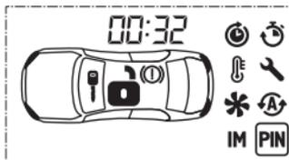
2. Увійдіть в режим установки ПІН-коду. При вимкненому запалюванні натисніть сервісну кнопку 4 рази. Кожне натискання супроводжується загорянням світлодіодного індикатора.
