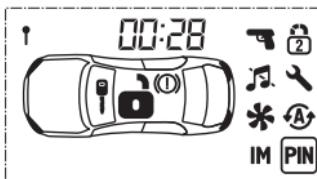
2. Увійдіть в режим установки ПІН-коду. При вимкненому запалюванні натисніть сервісну кнопку 4 рази. Кожне натискання супроводжується загорянням світлодіодного індикатора.
